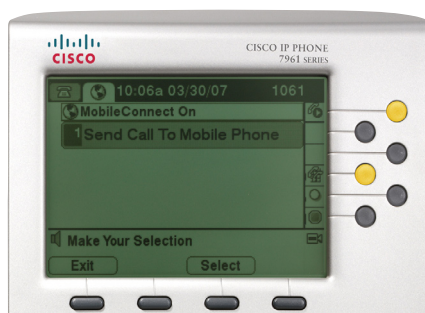
2. ábra A nagyfelbontású kijelző és a világító vonalgombok közelről
