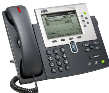
2. ábra A nagyfelbontású kijelző és a világító vonalgombok közelről
